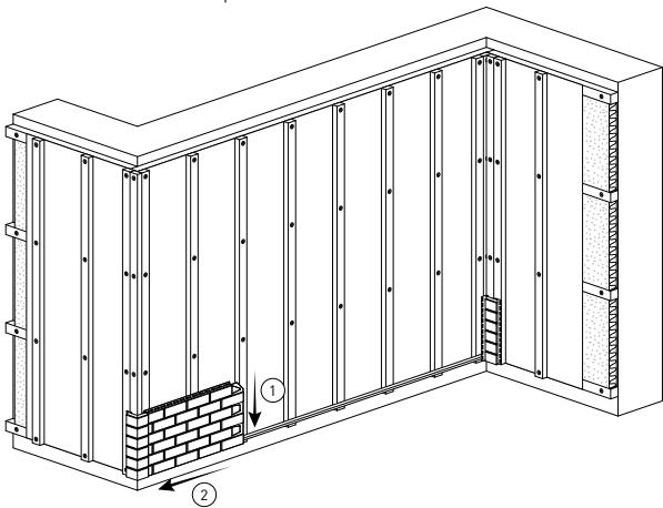
5. Шуруп вкручиваем по середине монтажного отверстия. Монтаж последней панели и предварительно обрезанного конца выполняется посредством несильного сгиба соединенных друг с другом элементов.
