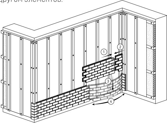
9. У верхнего края используется двухкомпонентная вентиляционная планка FS-262, сначала крепится нижняя часть планки. Затем монтируем последний ряд панелей, обрезанных до соответствующей высоты.
