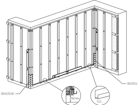
3. Первую панель зацепляем за планку S.LS..., прикручиваем панель шурупами в монтажные отверстия.
