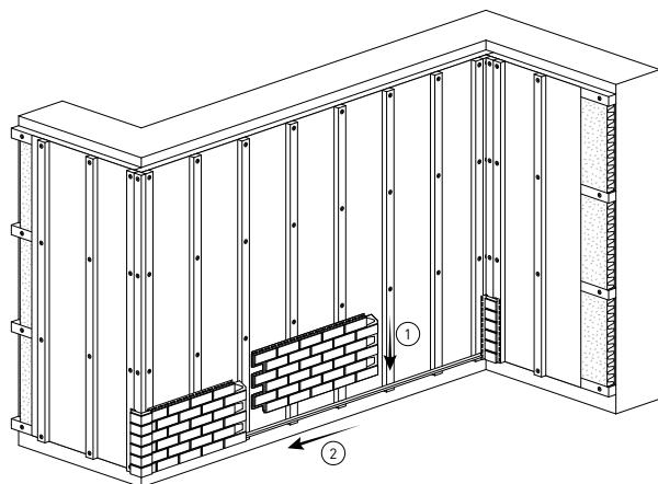
7. Монтаж последней панели и предварительно обрезанного конца выполняется посредством несильного сгиба соединенных друг с другом элементов.
