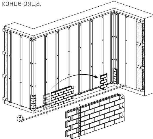
4. При монтаже необходимо оставлять температурный зазор так, чтобы была возможность переместить панель (ряд панелей) по горизонтали.
